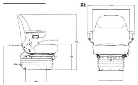
Кресло, оснащенное механической подвеской с 3-х позиционной регулировкой по весу и гидроаммортизатором.
